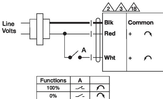
Transformador punto flotante AC 24 V
